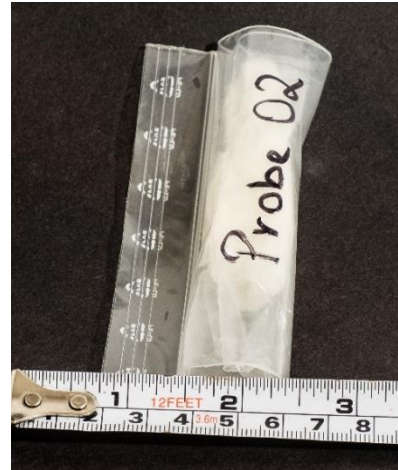
Abb.2b: Wischprobe zusammengerollt (ohne Lufteinschluss).
