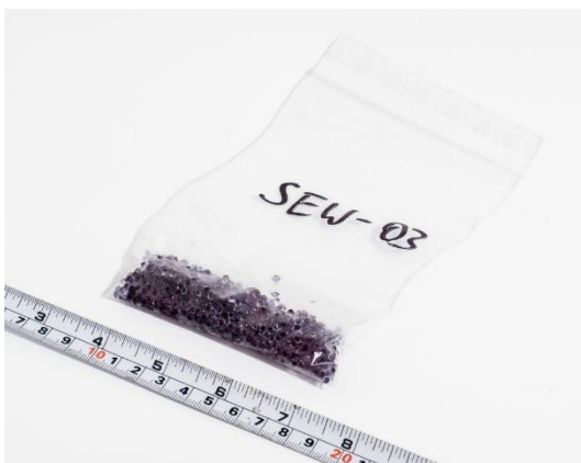
Abb.5c: Kieselgel nach Feuchteadsorption dunkel verfärbt.
