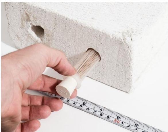
Abb.5a: Platzierung einer Kieselgelpatrone, Bohrloch 20mm.
